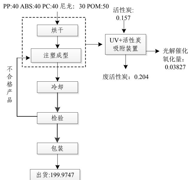
图 5-2 本项目物料平衡图 t/a
