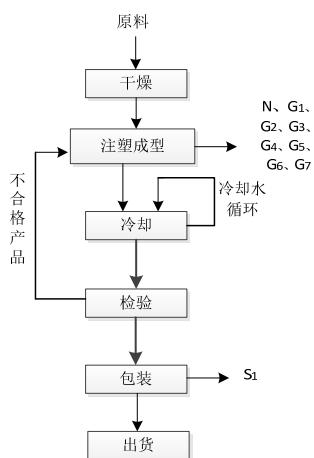
图 5-1 塑料粒子生产工艺流程及产污环节图
