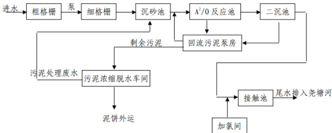
图 5-5 污水处理厂处理流程图
