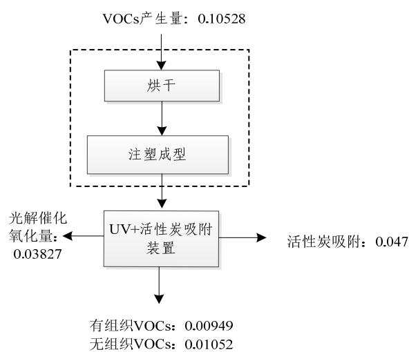
图 5-3 全厂 VOCs 平衡图 t/a
