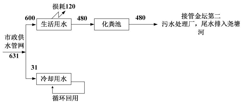
图 5-4 本项目水平衡图(m<sup>3</sup>/a)
